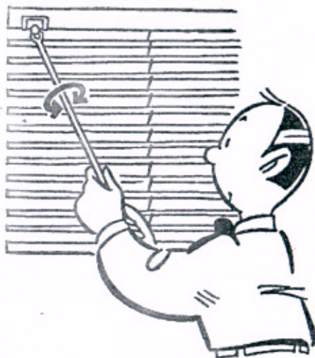
Pour orienter les lames du store, tournez la tige dans le sens approprié.
